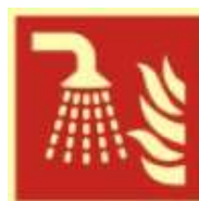
Stałe urządzenie gasnicze – instalacja tryskaczowa
