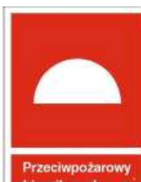
Przeciwpożarowy zbiornik wody ... m
